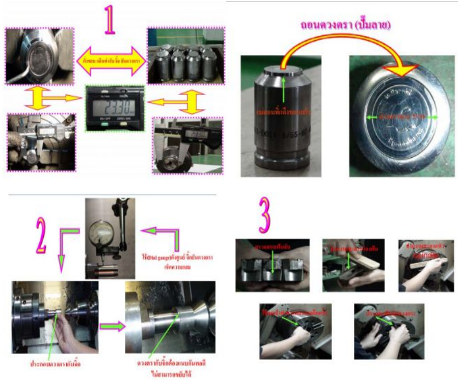
ภาพที่ 8 นวัตกรรมวิธีการกลึงดวงตราเหรียญกษาปณ์หมุนเวียนให้ได้ศูนย์ (Center)
